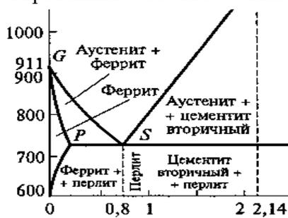
состоит в нагреве стали до температуры выше верхней критической точки  $A_{c3}$  на  $30-50^\circ$ , т. е. до температуры, немного превышающей температуру полного отжига, небольшой выдержке при этой температуре и последующем охлаждении на воздухе. Продолжительность выдержки тем больше, чем толще обрабатываемое изделие и чем грубее структура стали.
