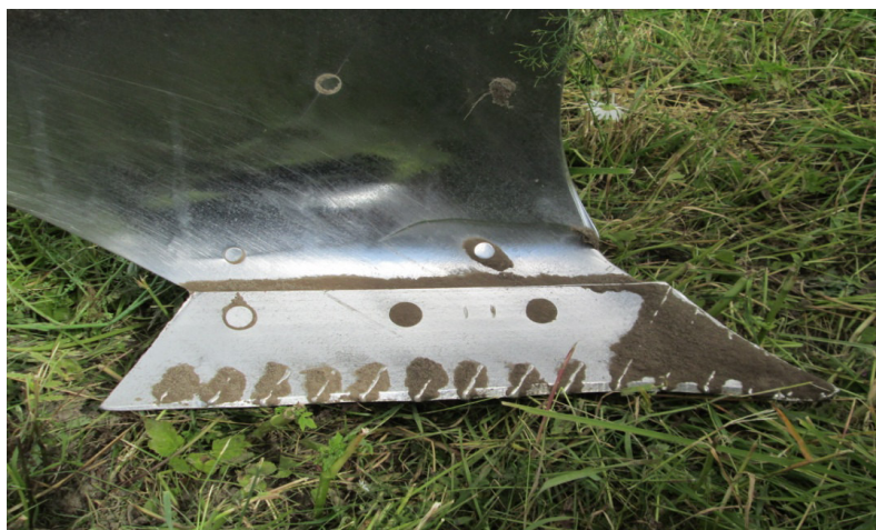
Рис. 4. Формирование застойных зон контактного слоя почвы при трении с поверхностью износостойкого присадочного материала
