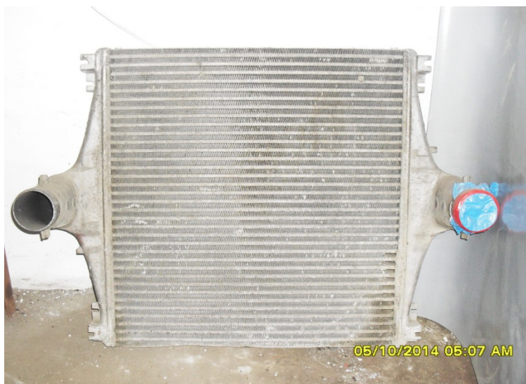
Рис. 4. Радиатор (интеркулер) импортного производства после ремонта
