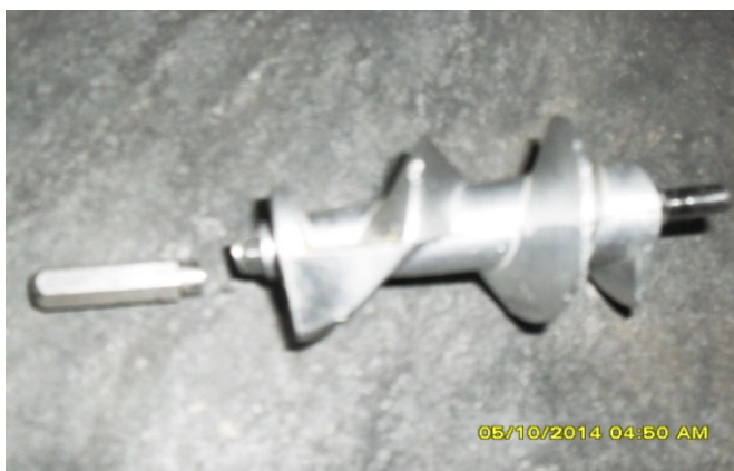
Рис. 2. Шнек в разрушенном виде
