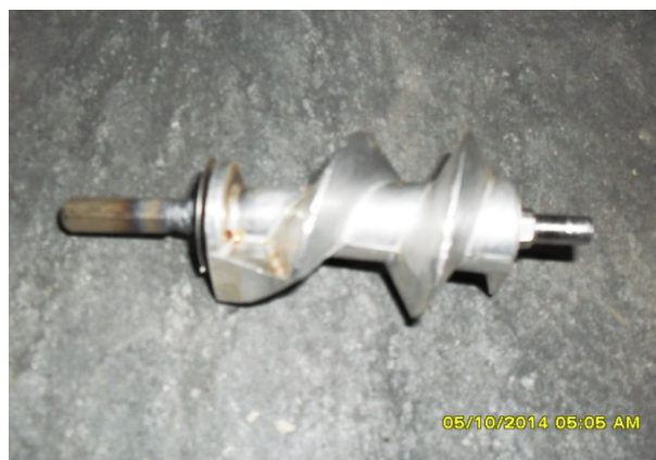
Рис. 3. Шнек после ремонта
