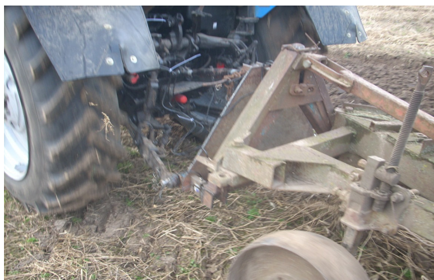
Рис. 5. Устройство для динамометрирования навесного плуга ПЛН-3-35 [9]
