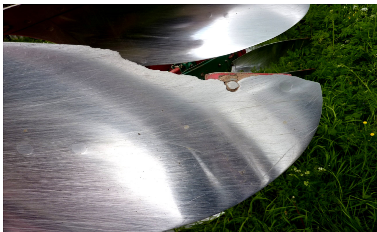
Рис. 1. Траектории направленного перемещения абразивных частиц на поверхности трения отвала корпуса плуга
