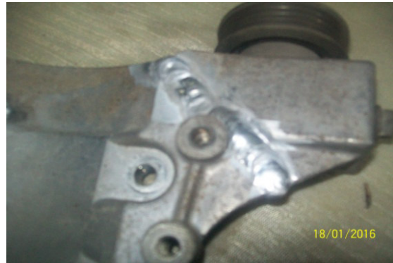
Рис. 5. Кронштейн крепления ролика натяжителя ремня: слева – до ремонта, справа – после ремонта
