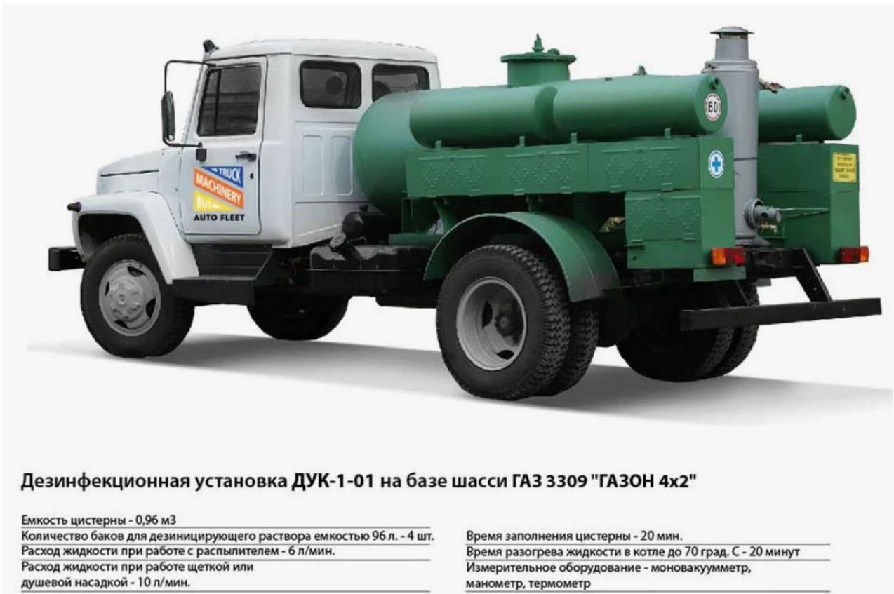
Рисунок 2. Дезинфекционная установка ДУК-1-01
