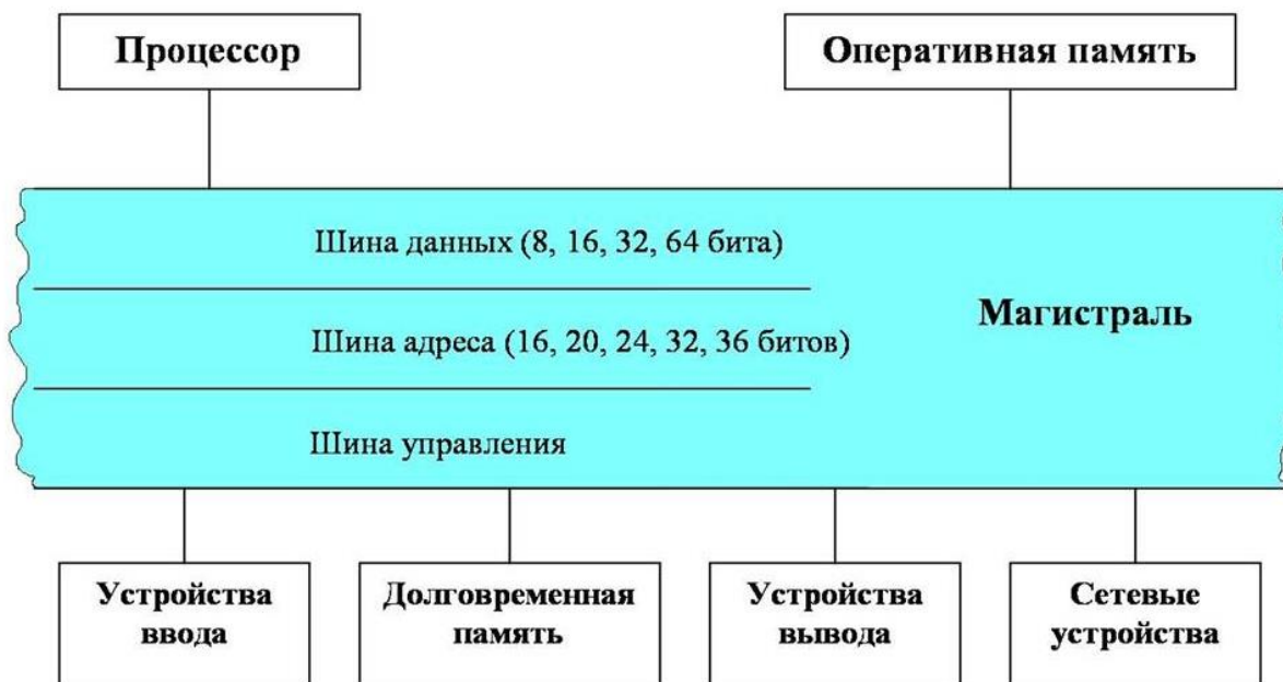
Рис. 3. Магистрально-модульный принцип построения персонального компьютера
