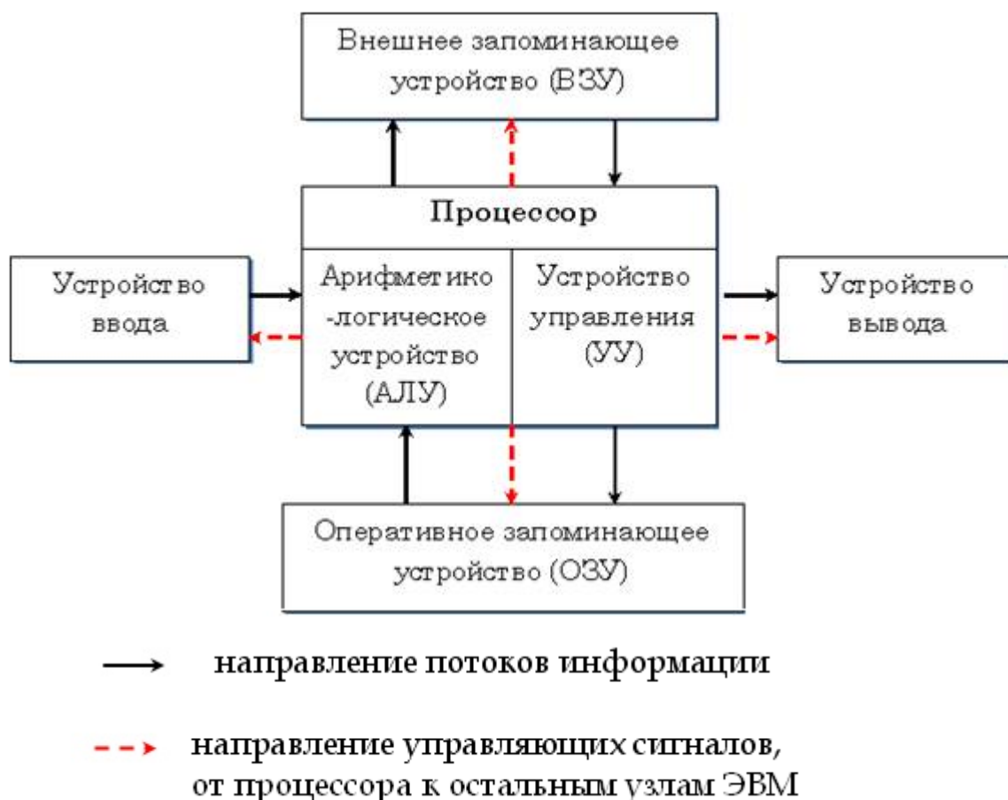
Рис. 2. Архитектура ЭВМ, построенная на принципах фон Неймана
