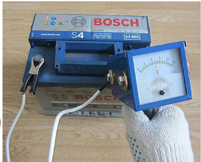
Рисунок 8 Проверка аккумуляторной батареи нагрузочной вилкой
