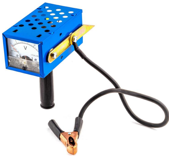
Рисунок 8 Проверка аккумуляторной батареи нагрузочной вилкой
