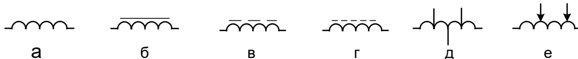
Рисунок 1.12. Условные графические обозначения катушек индуктивности: а- без магнитопровода; б- с магнитопроводом без зазора; в- с воздушным зазором; г- с магнитоэлектрическим сердечником; д- с выводами; е- со скользящими контактами.
