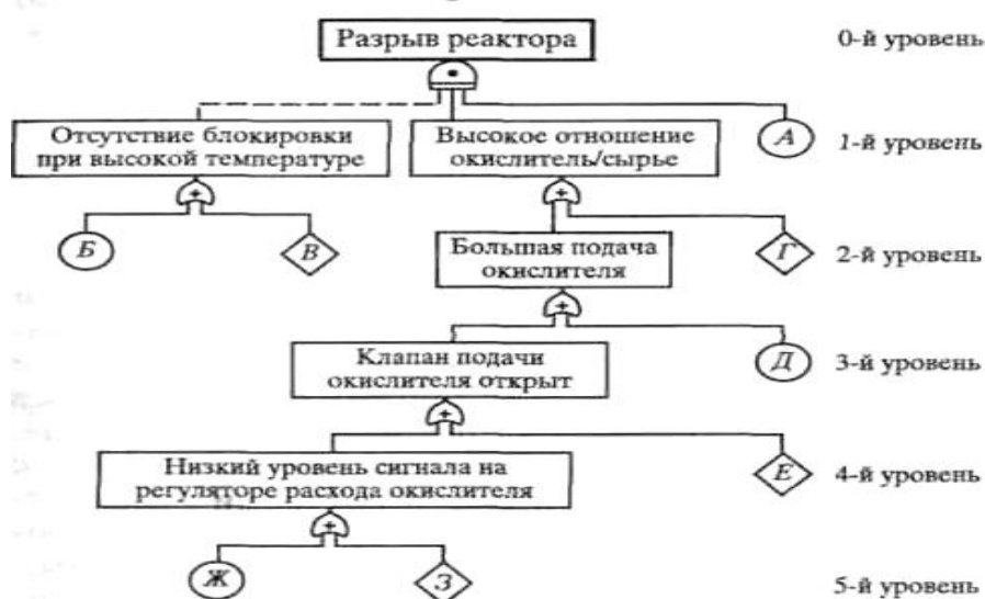
Рисунок 7- Разрыв химического реактора
