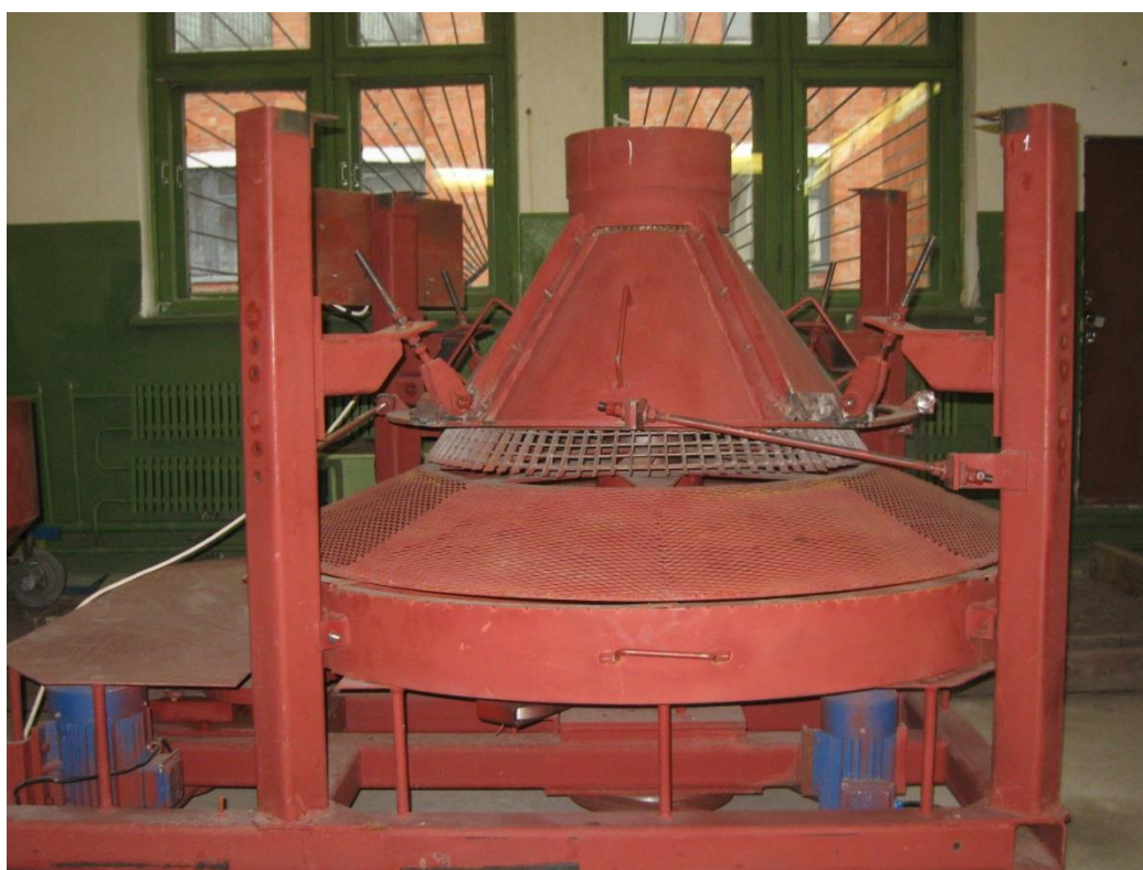
Рисунок 2 – Макетный образец молотильного устройства, реализующего поперечное знакопеременное воздействие на зерна в колосе
