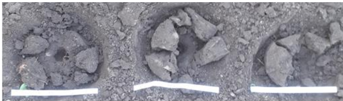
Рисунок 4 – Результаты деформации почвенных образцов при давлении сжатого воздуха 0,35МПа
