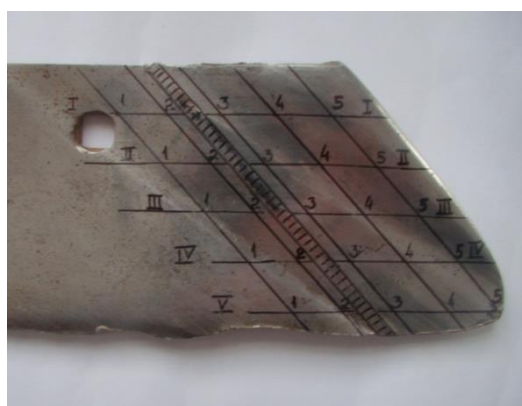
Рисунок 4 – Опытный лемех с нанесенными контрольными точками замеров твердости
