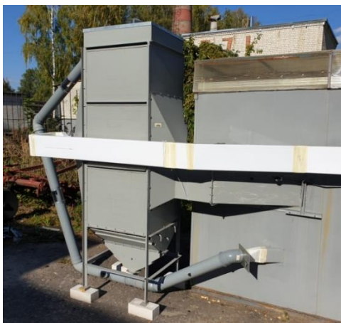
Рисунок 1 - Общий вид опытного образца модульной сушилки с аэродинамическим генератором теплоты
