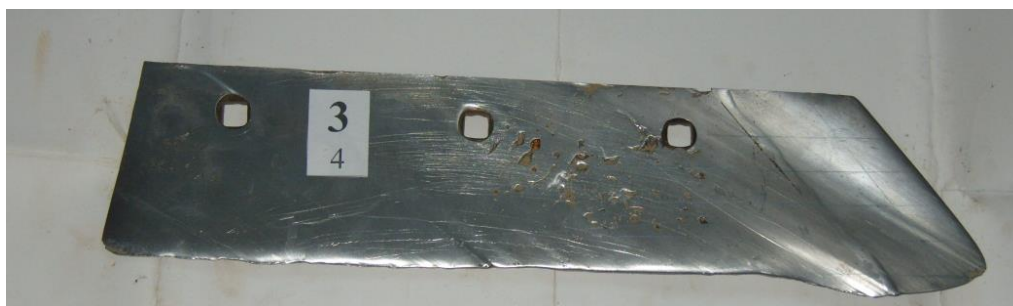
Рисунок 2 – Опытный лемех после наработки 14 га
