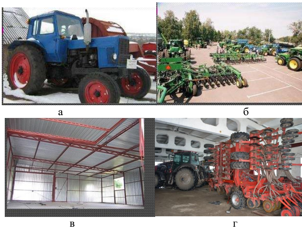
Рисунок 4 – Способы хранения техники открытая стоянка: а – отрицательная сторона; б – положительная сторона; в,г – закрытая стоянка
