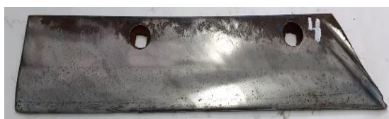
Рисунок 3- Лучевидный износ области носка с его изломом и износ лезвийной части
