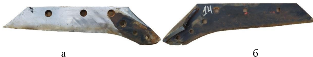
Рисунок 2 - Износ остова составного лемеха компании «КУН» (а – лицевая сторона лемеха, б – тыльная сторона)
