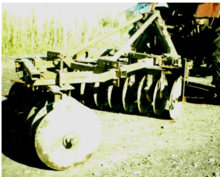
Рисунок 2 – Дисковая борона снабжена чистиком-отвальчиком
