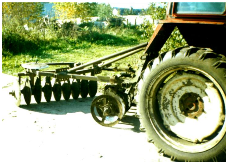
Рисунок 2 – Дисковая борона снабжена вырезным диском
