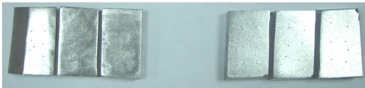
Рисунок 1 – Образцы для измерений твердости, вырезанные из лемеха фирмы Vogel & Noot
