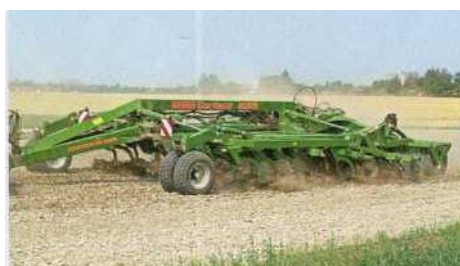
Рисунок 145 – Сдвоенные опорные колёса агрегата Centaur На основной раме закреплены 4 ряда лап.
