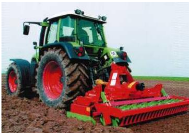
Рисунок 91 – Активная борона NG в работе
