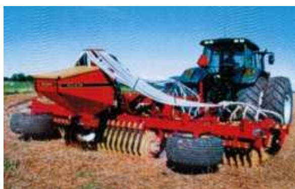
Рисунок 195 - Почвообрабатывающая машина Carrier преобразованная в сеялку для высева мелкосеменных культур
