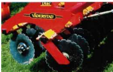
Рисунок 179 - Рабочая зона стерневых культиваторов Top Down с двумя рядами вырезных дисков
