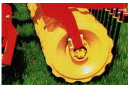
Рисунок 182 - Рабочая зона стерневых культиваторов Top Down в виде прикатывающего катка с чистиками
