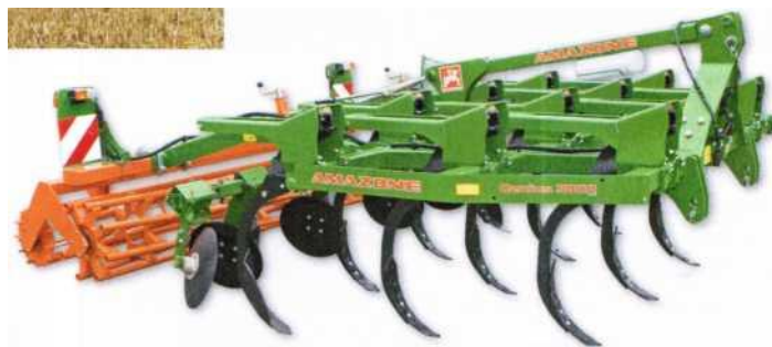
Рисунок 125 – Вид стоек 3D с предохранительным механизмом 5000 Н
