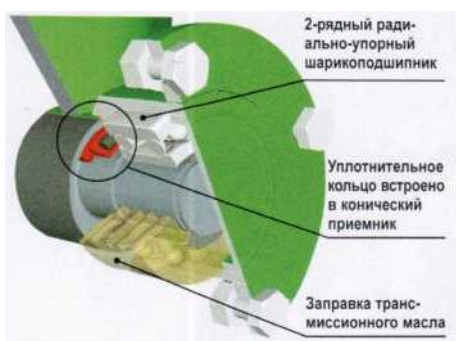
Рисунок 100 – Необслуживаемый подшипниковый узел
