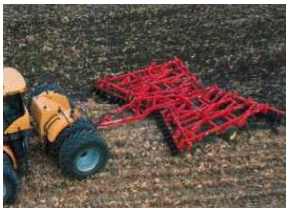
Рисунок 201 - Дисковый чизель-культиватор Sunflower 4511 в работе
