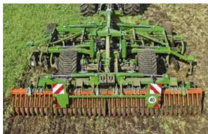
Рисунок 117 – Вид агрегата с катком и регулируемыми опорными колёсами в работе
