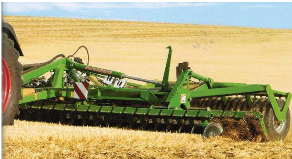
Рисунок 105 – Вид навесной бороны Catros в работе
