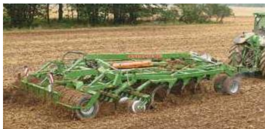
Рисунок 147 – Вид в работе комбинированного агрегата с четырьмя рядами рыхлительных лап
