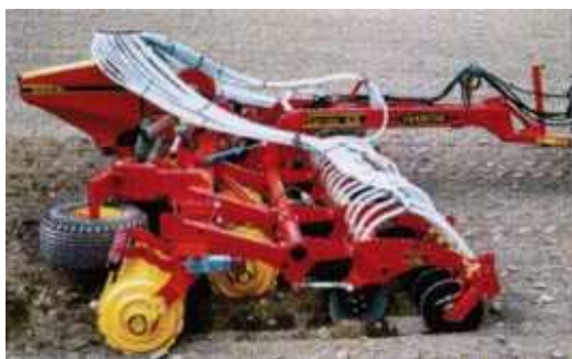
Рисунок 194 – BioDrill с прикатывающими колёсами и загортачами
