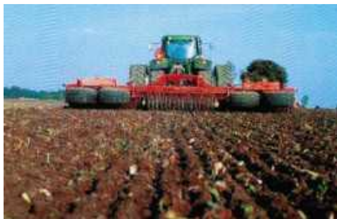
Рисунок 189 – Вид поля после прохода стерневого культиватора Carrier с тяжёлым катком в виде колец
