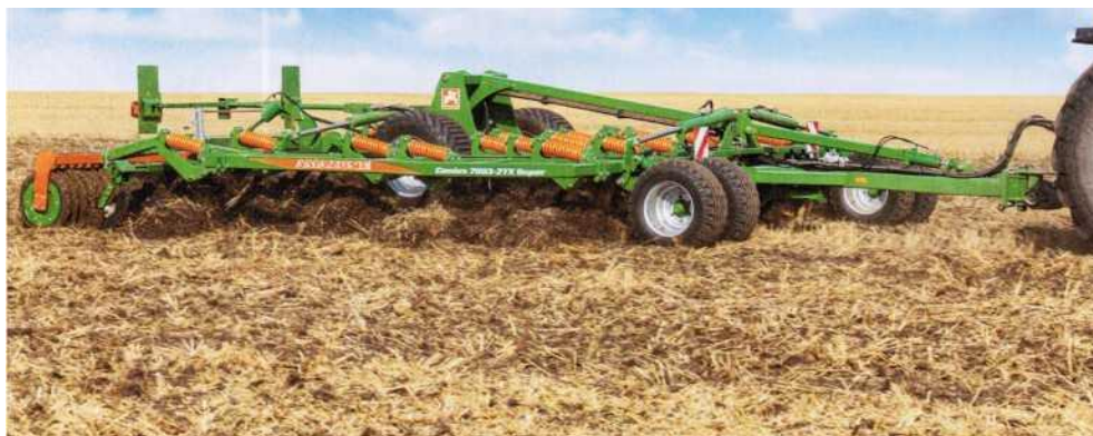
Рисунок 129 - Мульчирующий культиватор Cenius 7003-2TX Super с резино-клиновым катком
