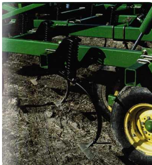
Рисунок 175 – Рабочий орган культиватора John Deere моделей 242 с пружинным предохранителем
