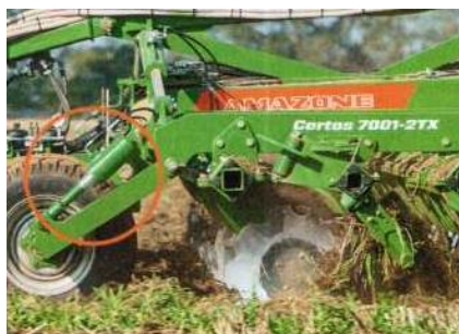
Рисунок 116 – Вид механизма бесступенчатой гидравлической настройки глубины обработки и посева
