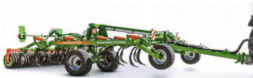
Рисунок 130 – Культиватор Cenius 5003-2TX Super с четырёхрядным расположением новых стоек
