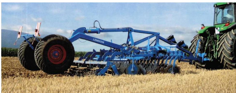
Рисунок 67 – Короткая дисковая борона Рубин в работе
