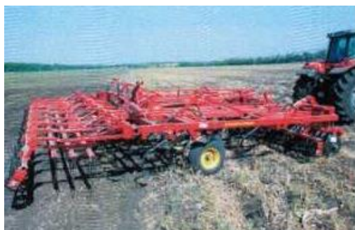
Рисунок 205 - Культиватор Sunflower 6000-17 с 6-ти рядной зубчатой бороной
