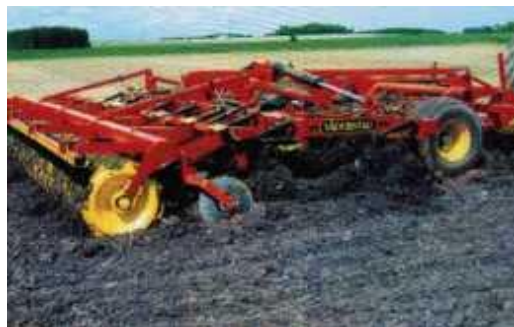
Рисунок 178 – Вид поверхности поля после прохода культиватора Top Down
