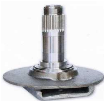
Рисунок 170 - Цельные держатели зубьев - Толщина стенок ванны 8 мм, диаметр валов 60 мм.
