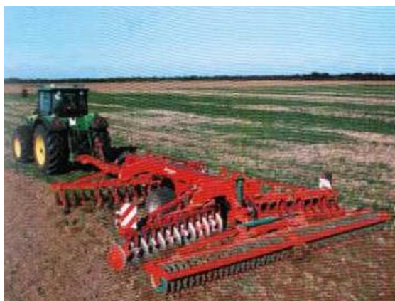
Рисунок 92 - Дисковая борона Visio в работе
