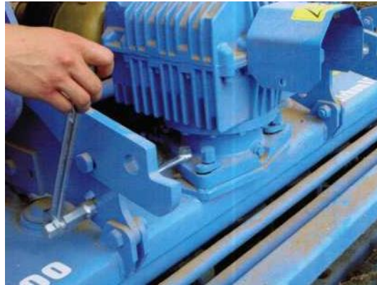
Рисунок 54 – Изменение направления вращения роторов
