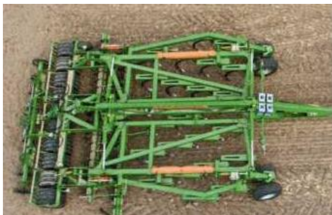
Рисунок 151 – Вид в работе комбинированного агрегата Centaur Super с дисковыми рабочими органами
