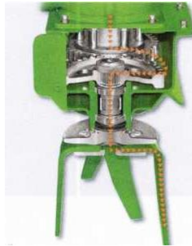
Рисунок 159 – Редуктор привода рабочего органа ротационной бороны KE
