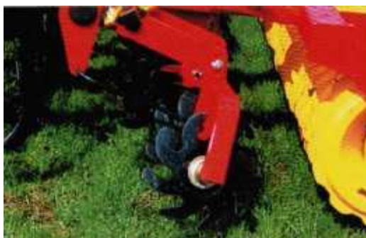
Рисунок 181 - Рабочая зона стерневых культиваторов Top Down в виде ряда вырезных дисков, расположенных попарно под углом друг к другу
