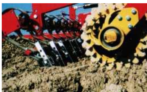
Рисунок 191 - Компоновка катка Rexius со шпоровыми кольцами Crosskill и выравнивающей доской Crossboard
