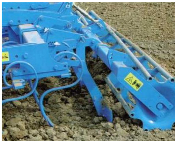
Рисунок 60 – Многофункциональная балка, установленная на активный срез.
