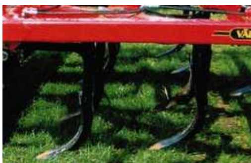
Рисунок 180 - Рабочая зона стерневых культиваторов Top Down из трёх рядов мощных долотообразных стоек
