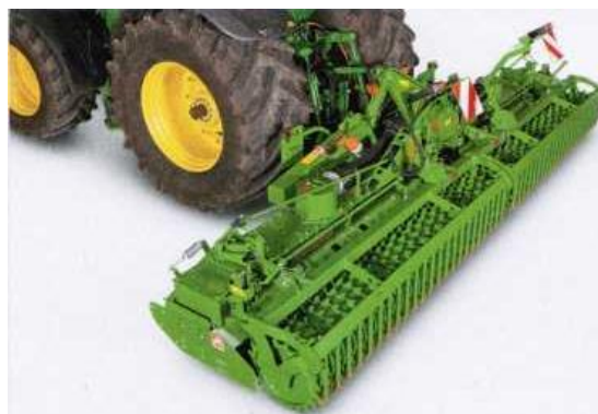
Рисунок 171 - Ротационные культиваторы с шириной захвата 5 м.
