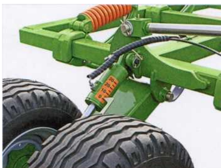
Рисунок 139 – Вид опциональной, бесступенчатой гидравлической настройки глубины
