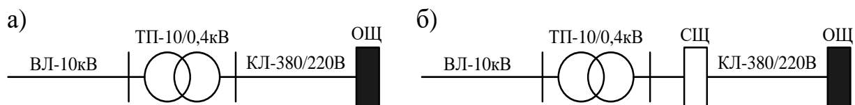
Рисунок 2.1 – Схемы электропитания осветительного щита
