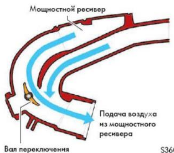
Рис. 4.6. Впускной коллектор с изменяемой геометрией двигателя FSI VR-6 3,2 л Volkswagen Passat
