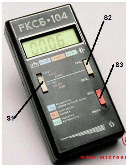
Рисунок 4.1 - Прибор РКСБ-104 "Радиян"
