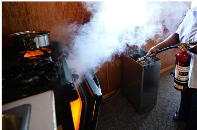
Рисунок 4.6 – Тушение пожара порошковым огнетушителем ОП-2
