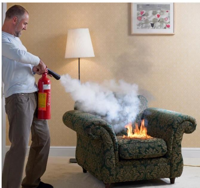
Рисунок 4.6 – Тушение пожара углекислотным огнетушителем ОУ-2
