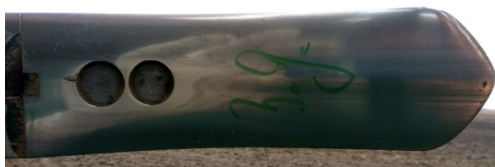
Рисунок 7 – Внешний вид долота заводского исполнения после наработки 32,2 га на деталь.
