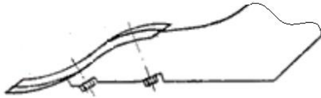
Рисунок 11 – Рабочий орган с обратным S – образным долотом
