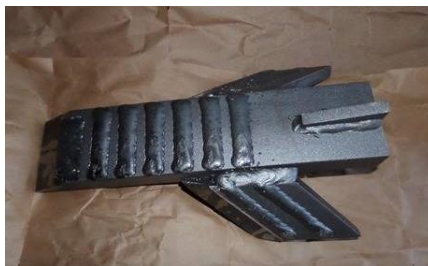
Рисунок 2 - Долото глубокорыхлителя 2460283 Earthmaster M & W 1700 (Фотография взята с https://flagma.ua/ )
