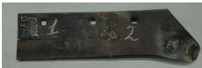
Рисунок 1 – Наплавленный материал на изношенные лемеха
