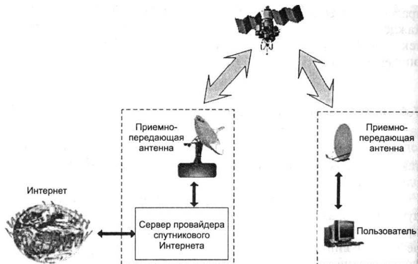
Рис. 5.2. Схема симметричного доступа в Интернет через спутник
