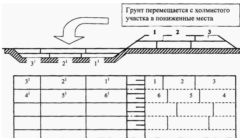
Рис. 5.1. Схема разработки выемки при продольном перемещении грунта
