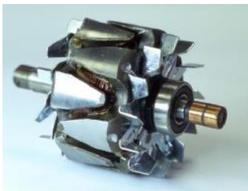
Рисунок 8 - Ключообразный ротор автомобильного вентильного генератора: 1 - полюсные половины южной системы; 2 - катушка обмотки возбуждения; 3- полюсные половины северной системы
