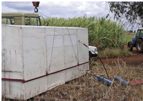
Рис. 3. Контейнер (приспособлен съемный автофургон) и баллоны с углекислым газом - оборудование для убоя свиней
