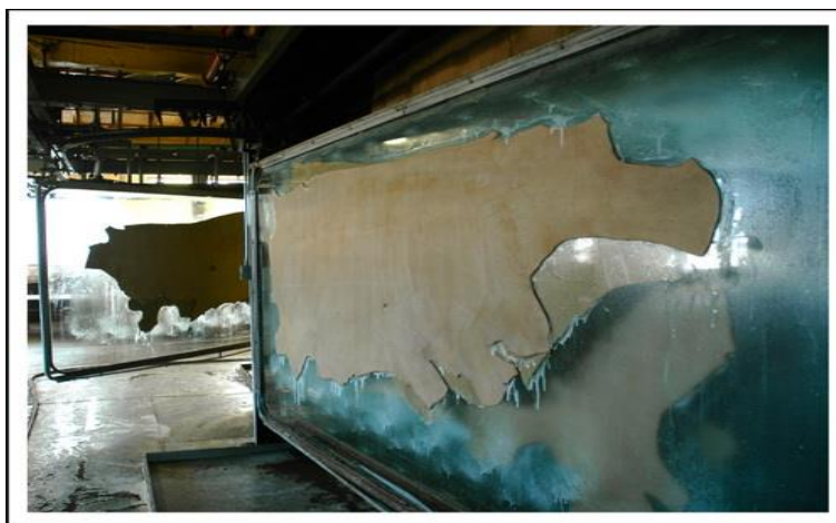
Рис. 19. Сушка шкур на поверхности стекла
