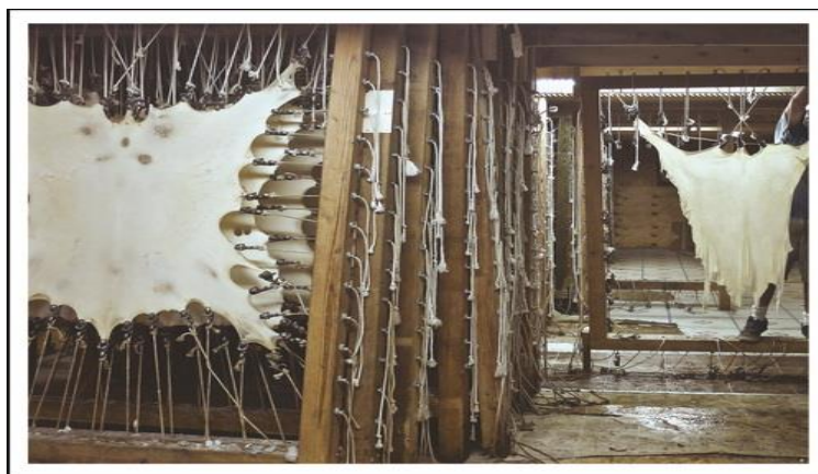
Рис. 17. Воздушная сушка путем подвешенных шкур
