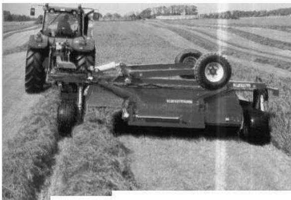
Рисунок 6.2 - Прицепная дисковая косилка GMS4802 фирмы «JF-Stoll» (Германия)
