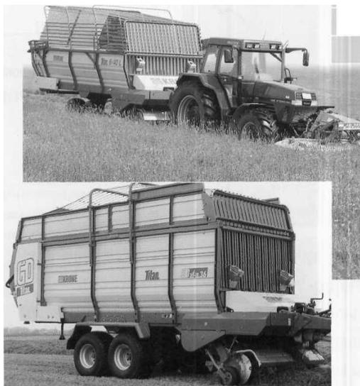
Рисунок 6.21 – Вид подборщика-измельчителя в агрегате с косилкой
