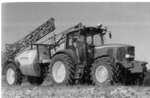
Рисунок 3.4 - Прицепной опрыскиватель JohnDeere 700-ой серии
