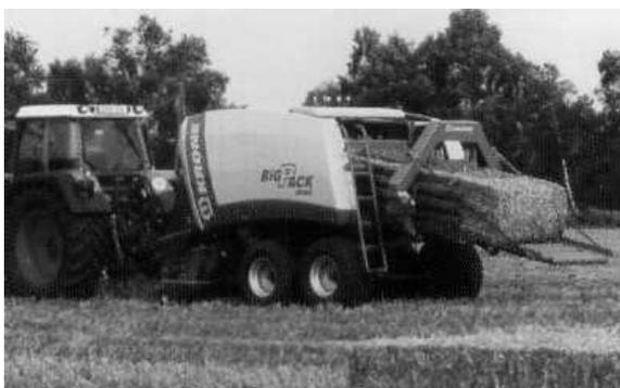
Рисунок 6.29 – Вид крупнопакующего пресс-подборщика с ротационным измельчителем ViGRack
