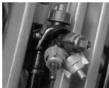
Рисунок 3.19–Четырёхпозиционные распылительные головки
