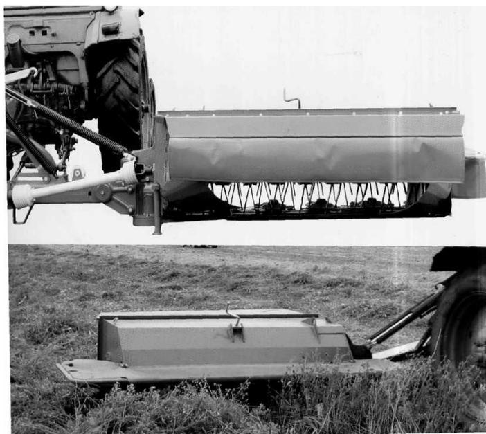
Рисунок 6.9 – Вид косилки с тонким режущим брусом
