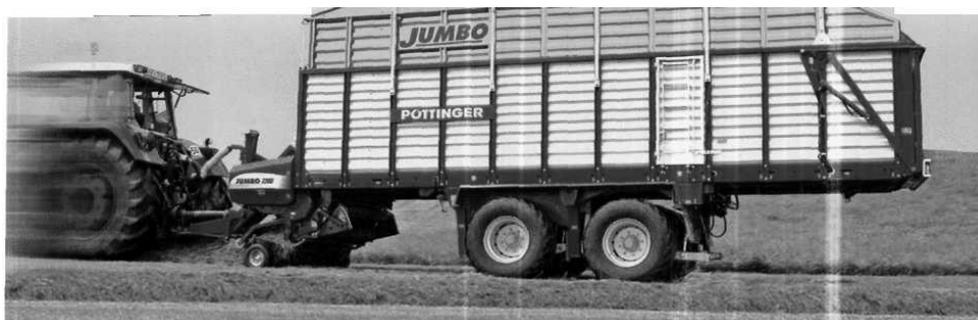
Рисунок 6.44 - Вид подборщика-накопителя с дозатором
