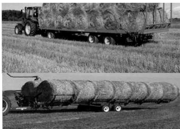
Рисунок 6.42 – Вид тележки-подборщика рулонов
