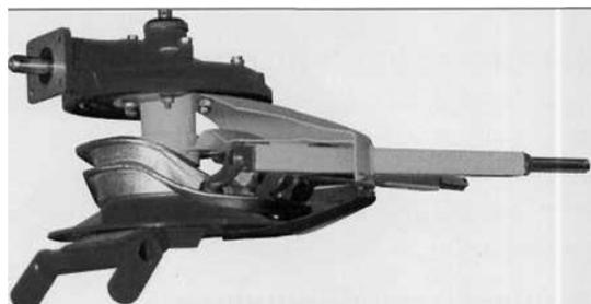
Рисунок 6.27 – Вид направляющей дорожки поворотного механизма граблин
