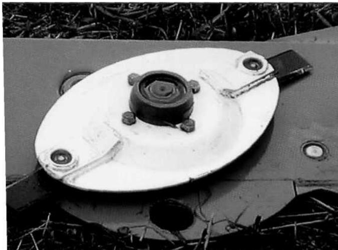
Рисунок 6.10 – Роторы овальной формы
