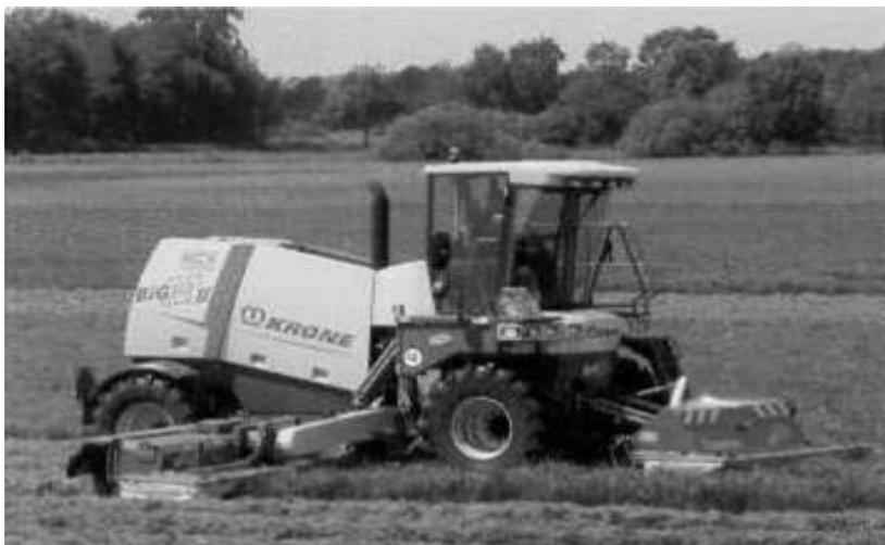
Рисунок 6.1 – Вид самоходной косилки-плющилки ViGM фирмы Кроне
