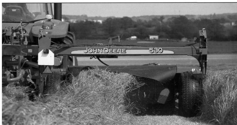
Рисунок 6.14 – Вид гидроуправляемых приводных щитков
