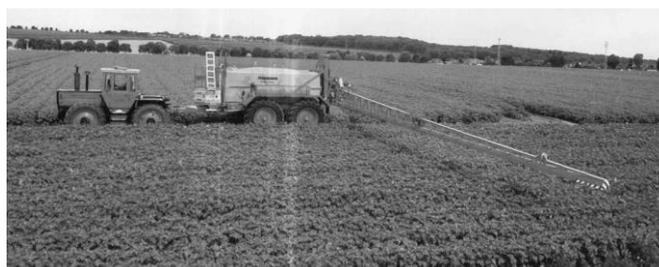
Рисунок 3.5 - Прицепной опрыскиватель UGNova фирмы Amazone.
