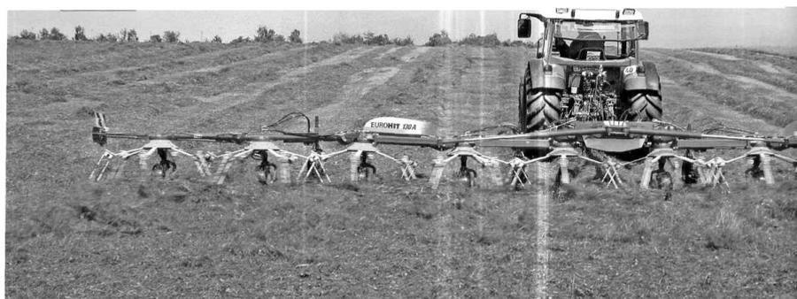
Рисунок 6.22 – Задненавесная роторная ворошилка серии KW
