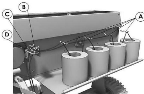
Рисунок 5.23 – Установка бухт шпагата: А – верхние проушины; В – механизм натяжения шпагата; С и D – отверстия
