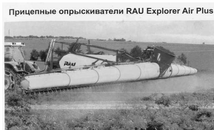
Рисунок 3.22 – Вид опрыскивателя с принудительным осаждением капель воздушным потоком
