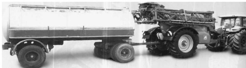
Рисунок 3.6 – Опрыскиватель с дополнительным прицепом
