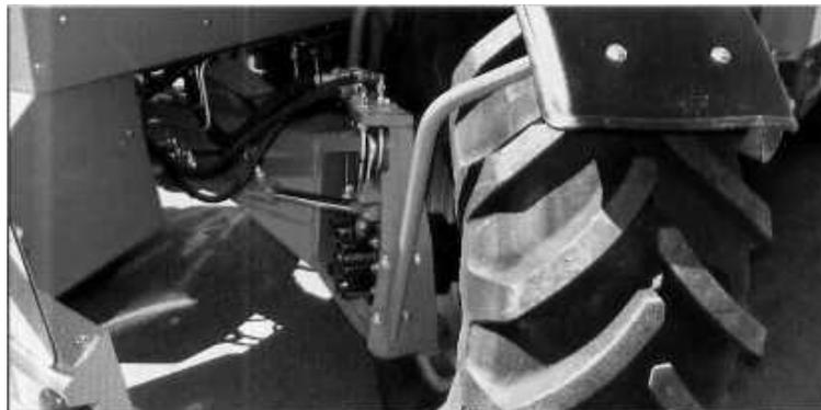
Рисунок 6.5 – Гидропривод колёс
