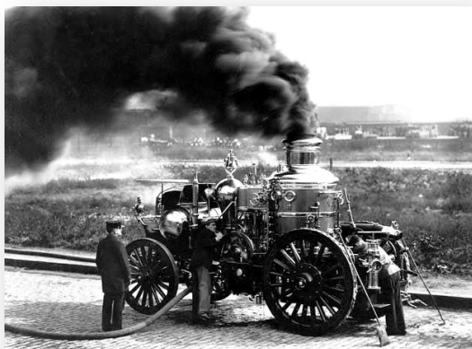
Рисунок 11.5 - Подготовка парового насоса
