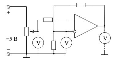
b. Изменяя напряжение на входе неинвертирующего усилителя (среднем выводе переменного резистора) измеряйте напряжение на выходе ОУ и на инвертирующем входе ОУ. Сделайте около 10 измерений. Данные занесите в таблицу
