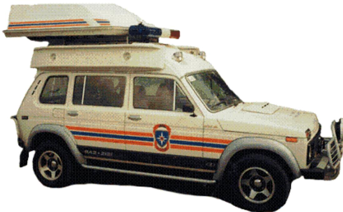
Рисунок 5 - АСМ-41-01 на базе ВАЗ -2131с высокой крышей и пластиковой лодкой
