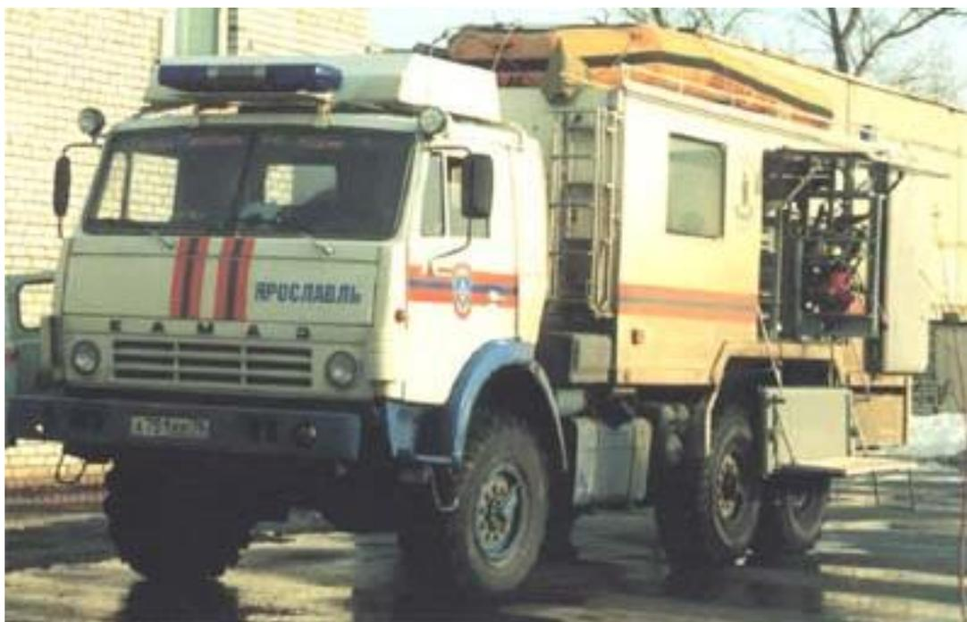
Рисунок 1.- АСМ-5827-0000010 тяжелого класса на шасси КАМАЗ-43101
