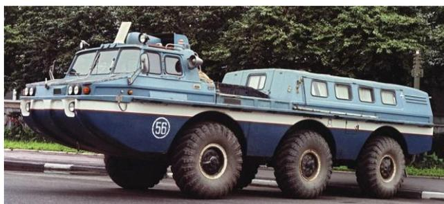
Рисунок 3- Аварийно-спасательные плавающие машины высокой проходимости: а) ЗИЛ-4906 (грузовой); б) ЗИЛ 49061 (пассажирский)
