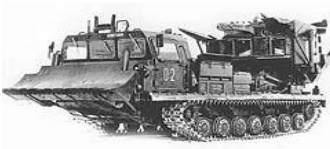
Рисунок 28- Котлованная машина МДК-3
