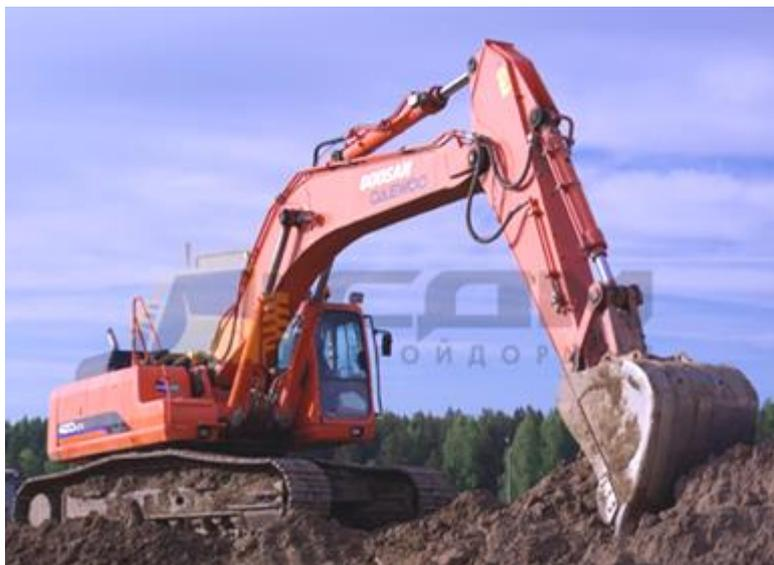
Рисунок 31- Одноковшовый экскаватор
