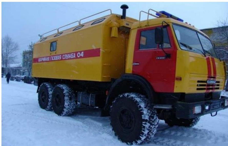
Рисунок 15- Фургон - мастерская «Аварийной службы» на шасси КАМАЗ – 43118
