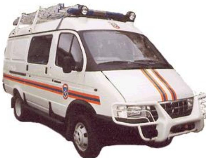
Рисунок 4- АСМ-41-02 на шасси ГАЗ-27057 «Газель»
