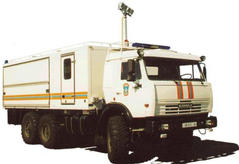
Рисунок 2- АСМ «Спасатель» АСМ-48-03 тяжелого класса на шасси КАМАЗ-43118-1048-13
