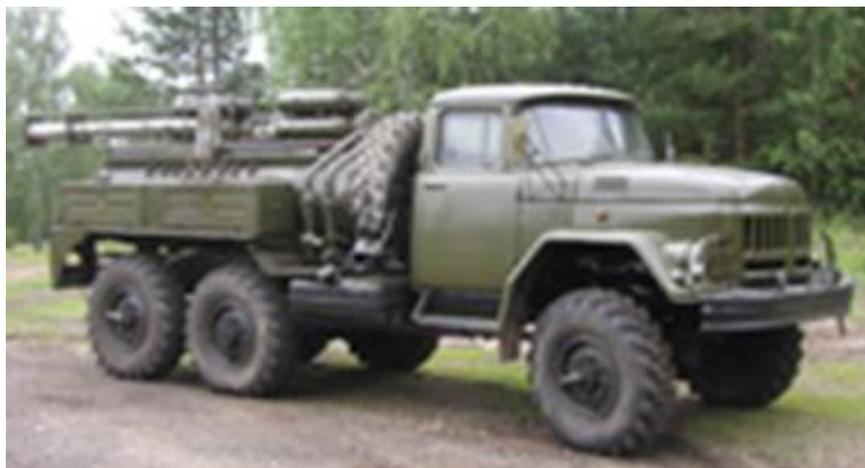
Рисунок 22- Авторазливочная станция АРС-14
