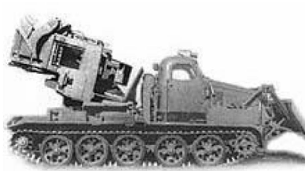
Рисунок 27 - Котлованная машина МДК-2
