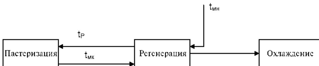
Рисунок 15.21 - Схема процесса регенерации
