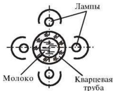
Рисунок 15.23 - Схема актинатора
