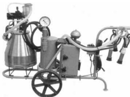
Рисунок 14.8 - Общий вид передвижной доильной установки с аппаратом «Нурлат»
