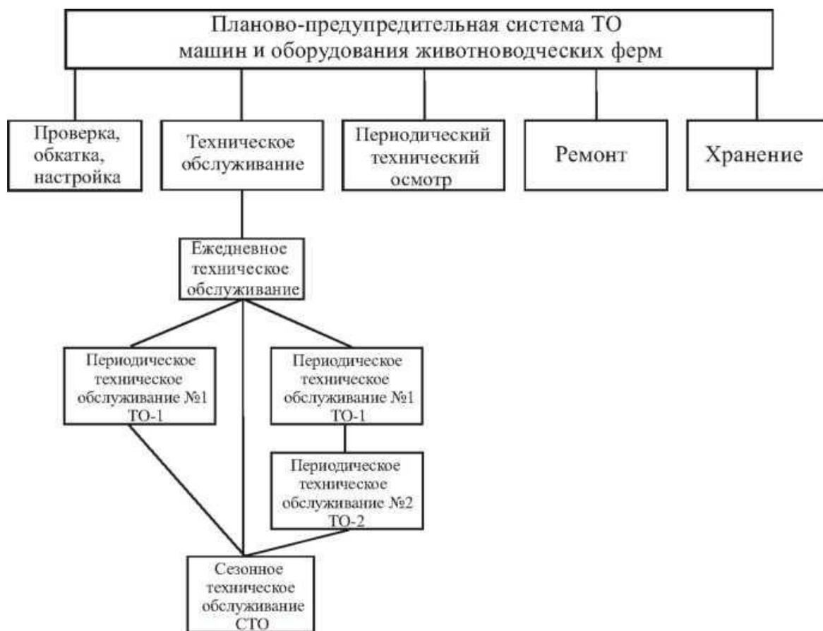
Рисунок 16.1 - Схема планово-предупредительной системы ТО
