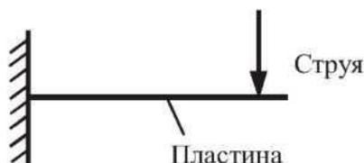
Рисунок 15.26 - Схема действия гидродинамического вибратора
