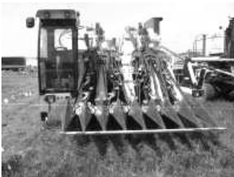
Рисунок 4.4 – Самоходная льнотеребилка ТСЛ-2,4
