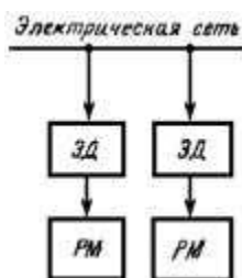
Рис. 3. Структурная схема группового электропривода
