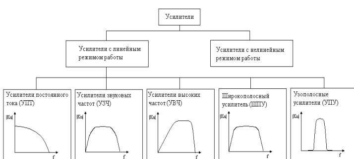
Рис. 12. Классификация усилителей по типу режимов работы.
