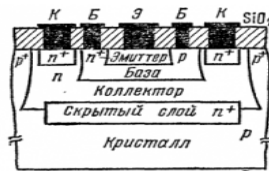
Рис. 4. Интегральный биполярный транзистор, изолированный электронно-дырочным переходом
