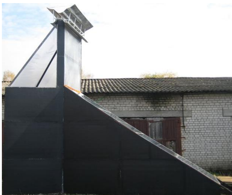
Рисунок 1 – Опытный образец барабанной гелиосушилки
