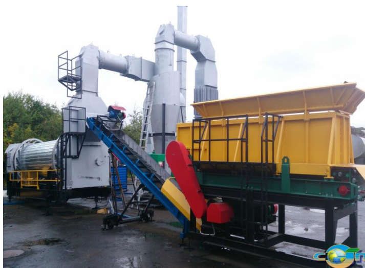
Рисунок 2 – Установка для утилизации замазученных грунтов
