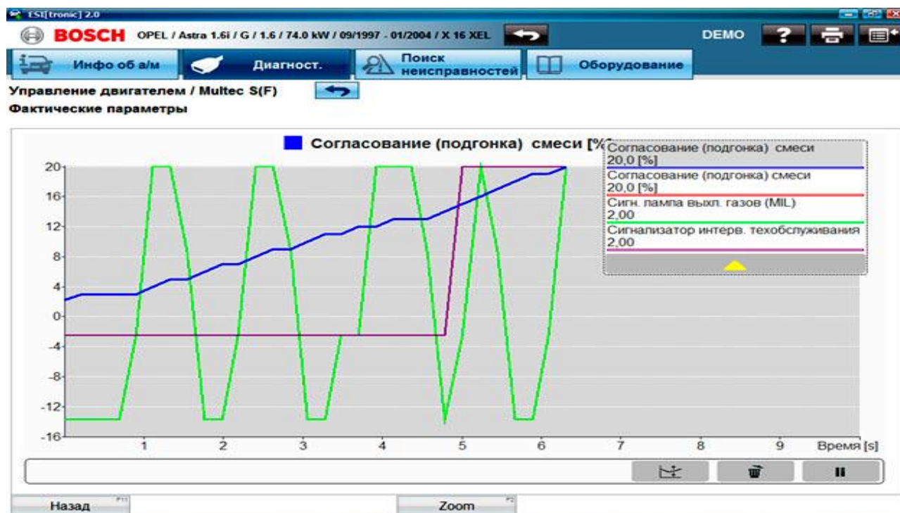
Рис. 4.10. Отображение измеряемых значений для выбранных фактических параметров в графическом виде
