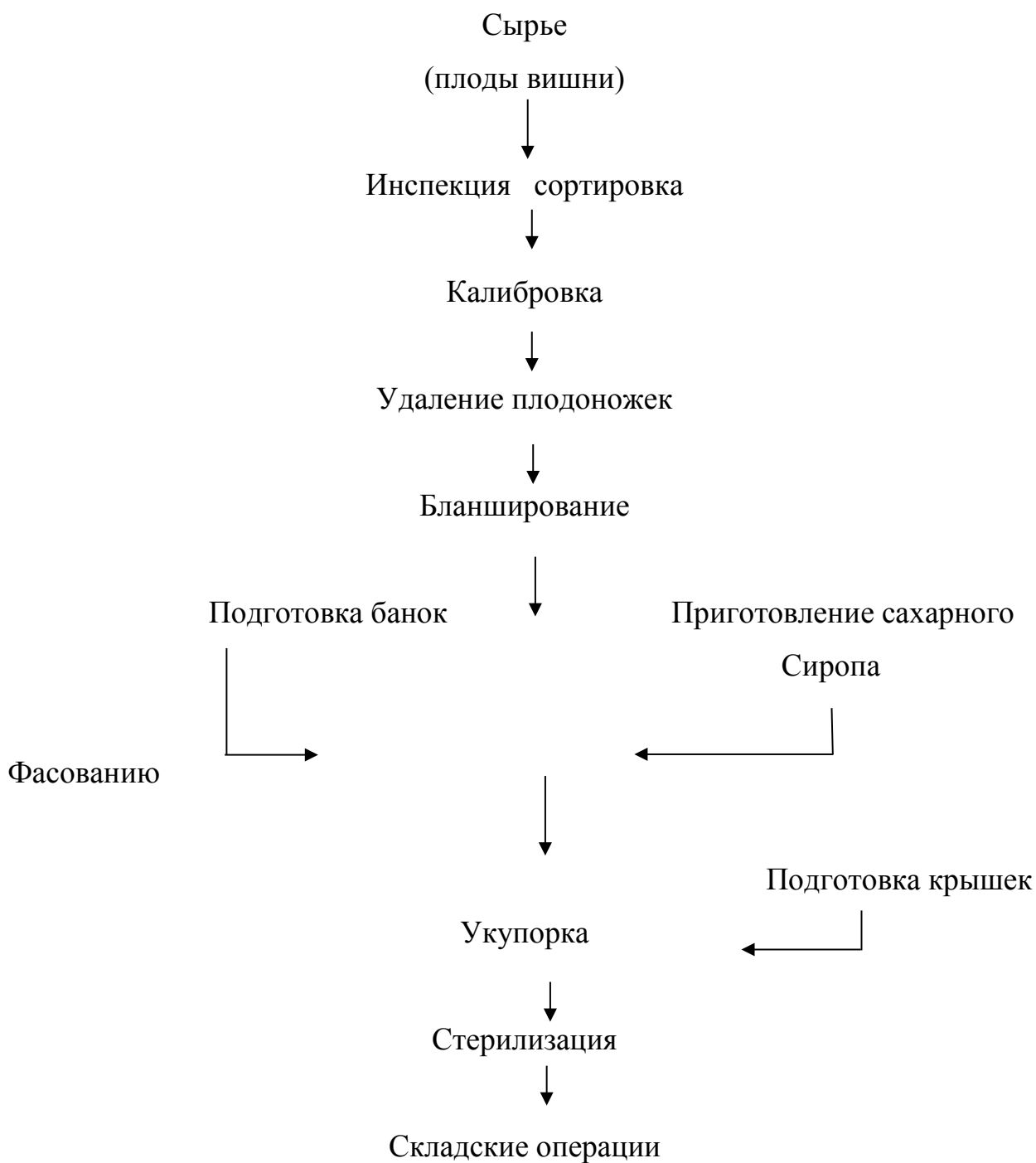
Рис. 1. Технологическая схема производства консервов «Вишневый компот»
