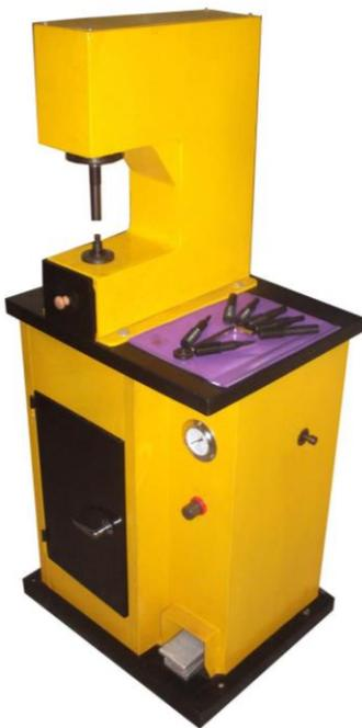
Рисунок 2.2 – Пневмогидравлический стенд ТТН-410
