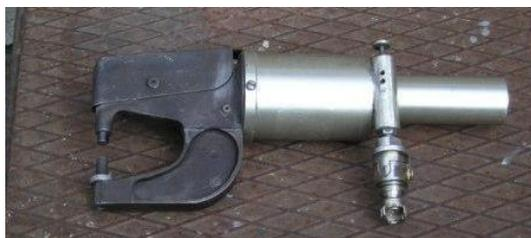
Рисунок 2.7 – Пресс ручной пневматический РПП–1
