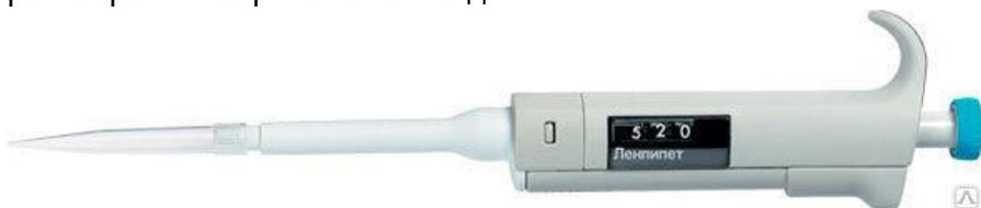
Рис. 2. Дозатор с наконечником
