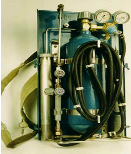
Рисунок – 7 Ранцевая установка для термической резки металла УТР/Р-ЗБН
