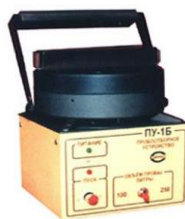
Рис.52. Устройство автоматического тбора проб воздуха – ПУ-1Б
