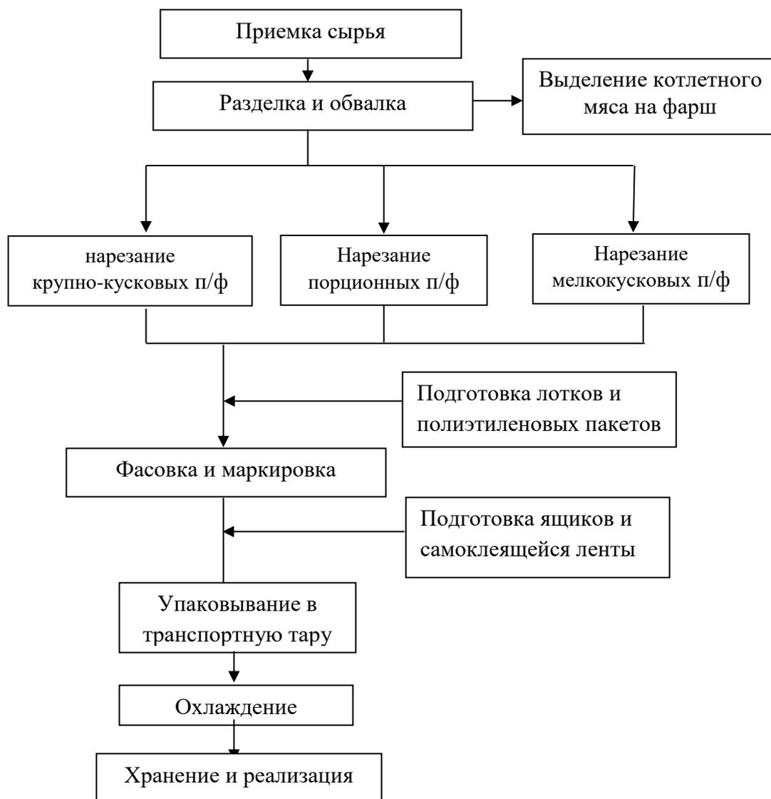
Рис. 1 – Технологическая схема изготовления натуральных полуфабрикатов
