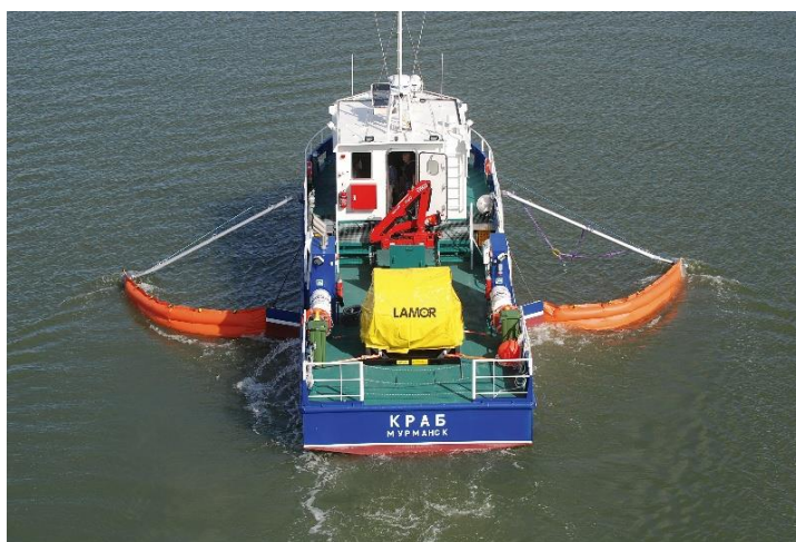
Рисунок 8.3 - Катер-нефтесборщик со встроенной системой сбора аварийных разливов нефти
