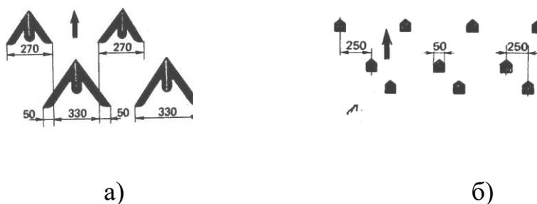
а) со стрелчатыми лапами; б) с рыхлительными лапами;
