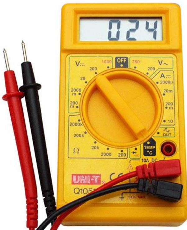
В данном случае один из выводов омметра нужно подключить к одному из выводов разъема. Вторым выводом омметра мы проверяем провода на другом конце кабеля. Когда прибор покажет нулевое сопротивление, помечаем кабель как исправный и запоминаем его назначение.
