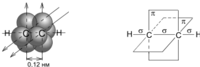
Рис. 5. Схематическое изображение строения молекулы ацетилена
