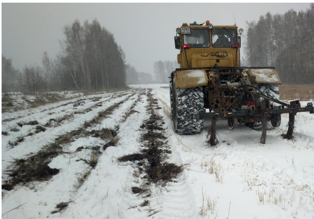
Рисунок 4 – Применение вибрационного глубокорыхлителя на тракторе К-700 для сплошной обработки, замерзшей на глубину 0,15 м почвы.
