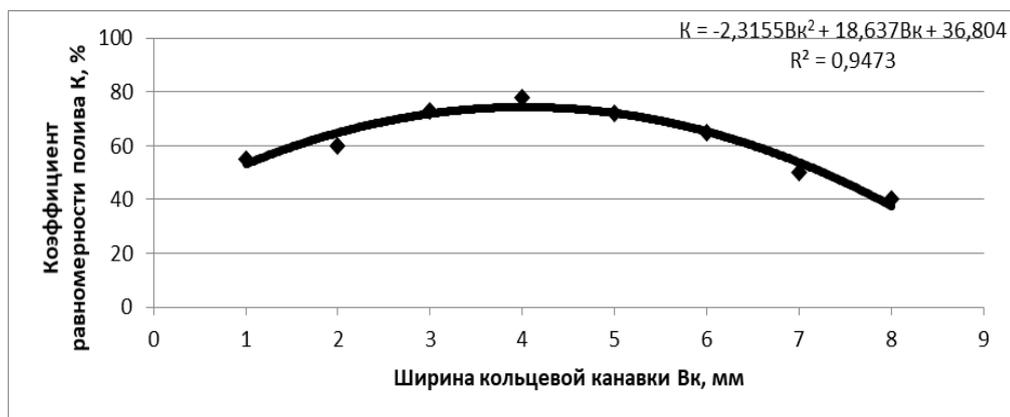
Рисунок 4 - Влияние ширины кольцевой канавки на коэффициент равномерности полива
