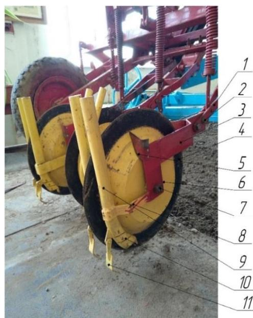
Рисунок 2. Лабораторная установка для исследования макетных образцов однодисковых сошников с симметричными усеченно-конусными бороздкообразователями: 1 – поводок; 2 – крепежные болты; 3 – корпус; 4 – диск на 400 мм; 5 – чистик; 6 – усеченно-конусная реборда-бороздкообразователь; 7 – ось; 8 – пластина; 9 – семянаправитель; 10 – шкала глубины бороздки; 11 – клапан
