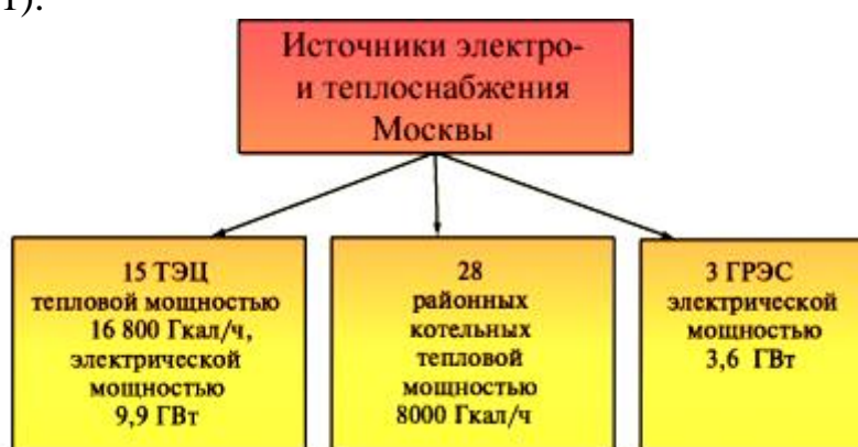
Рис 4.11. Структура источников электрической и тепловой энергии Москвы.
