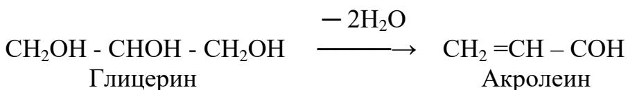
В пробирку наливают 0,5 мл масла, прибавляют избыток безводного  $\text{KHSO}_4$  и осторожно нагревают на пламени горелки до появления белых густых паров и специфического запаха акролеина. Гидросульфат калия при сильном нагревании образует пиросернокислый калий  $\text{K}_2\text{S}_2\text{O}_7$ , который проявляет сильные водоотнимающие свойства.
