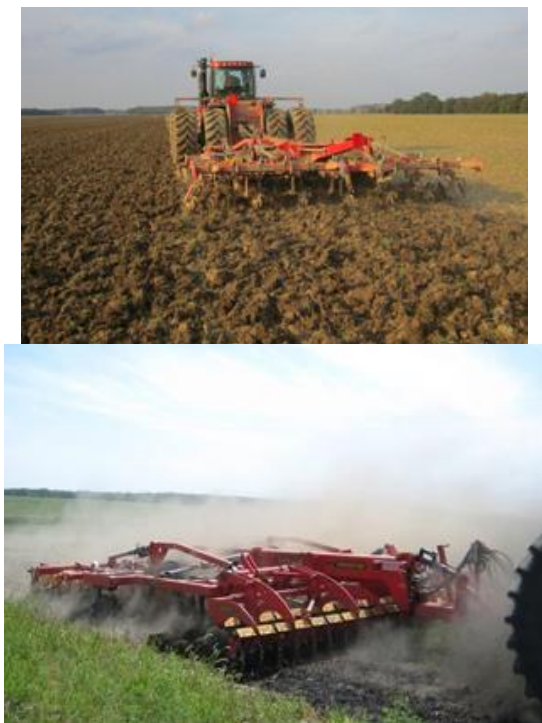
Рис. 3. Дисколаповый культиватор TopDown в действии
