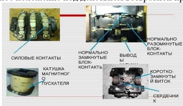
Рисунок 3 – Устройство магнитного пускателя
