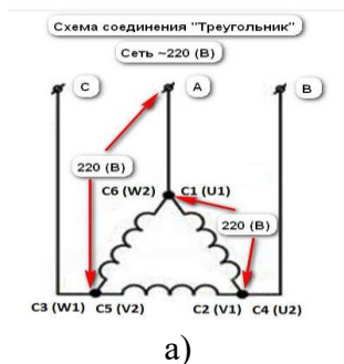
Рисунок 4 – Схема соединения «Треугольник»: а) принципиальная электрическая; б) на клеммнике
