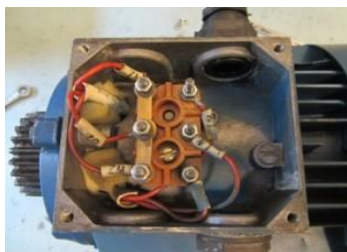
Рисунок 1 – Выводы обмоток электродвигателя
