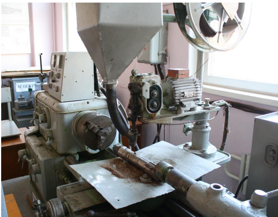
Рисунок 5 – Общий вид установки для наплавки деталей под слоем флюса
