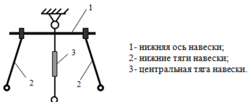
Рисунок 1 – Трёхточечная схема навески трактора
