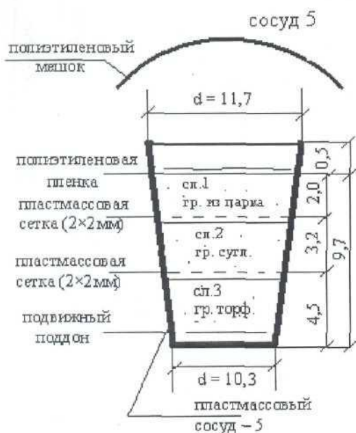
Рис. 3.14-8 Схема засыпки грунта в сосуд -5 и создание условий малого испарения.
