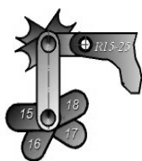
Радиусомер, состоящий из набора пластинок, на которых выбиты величины радиусов (мм), замеряют радиусы закруглений (галтелей).
