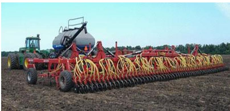
Рисунок 11 - Агрегат для прямого посева «Терминатор»
