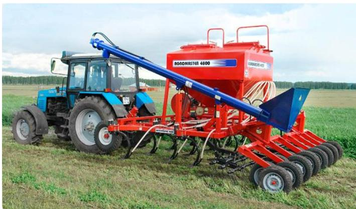
Рисунок 10 - Агрегат для прямого посева Agromaster 48000
