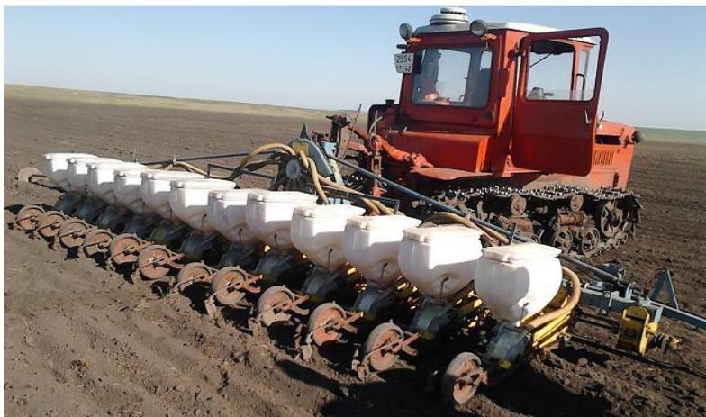
Рисунок 19 - Сеялка точного высева MULTICORN SK – 12
