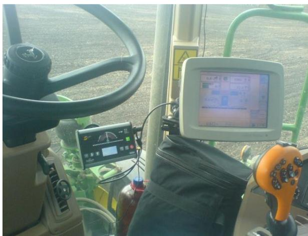
Рисунок 2 - Трактор, оборудованный системой навигации
