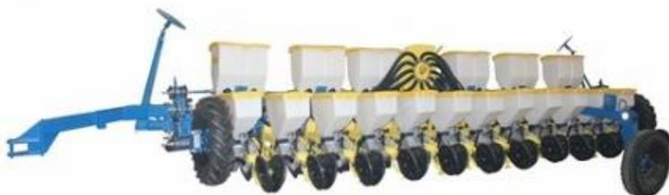
Рисунок 18 - Сеялка точного высева Ритм-1
