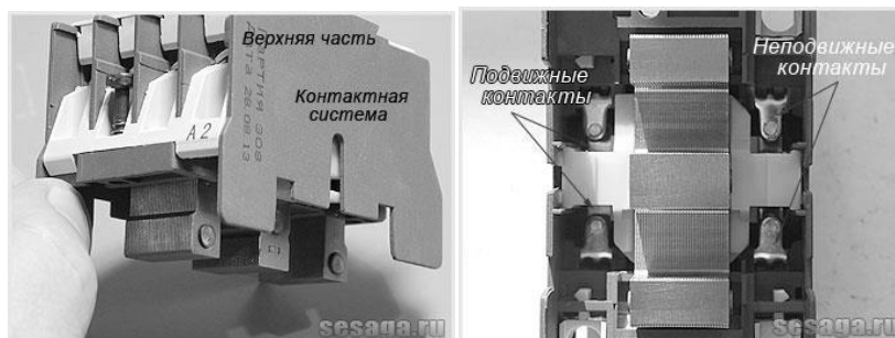
Рисунок 2 – Устройство верхней части магнитного пускателя
