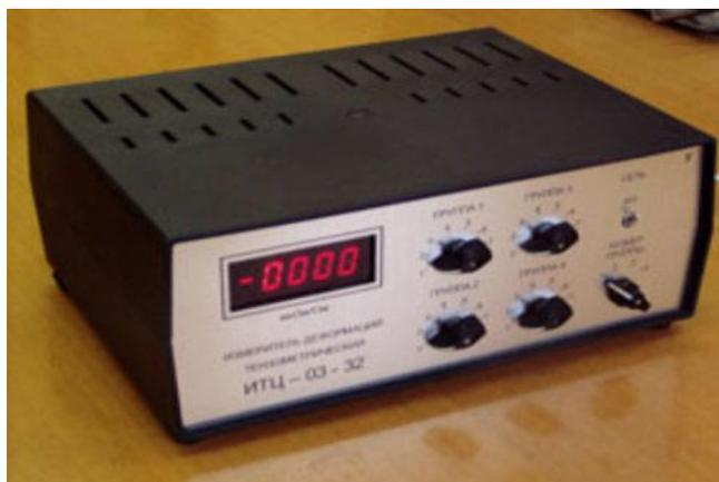
Рисунок 2 – Измеритель деформации
